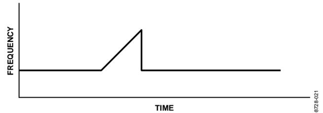
Figure 28. Single Sawtooth Burst
